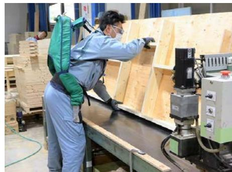
重さ約20kgにもなるパネルにくぎ打ちを行い別の棚に移し替えていく。この作業は従業員1名で行うため、疲れが出て作業効率下がってしまうことがあった。マッスルスーツ®でその負荷を軽減し、身体を守りながら安心して作業に集中することができる。
