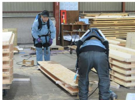
膝の高さにあるパネルをペアで持ち上げ・運ぶ作業。持ち上げる際には中腰にならないため、腰痛の原因になっていた。ここで使用されているマッスルスーツ® スタンドアロンモデルのソフトフィットは、腿パッドと腿の間に少し空間ができるよう設計されているため、容易に歩くことができる。
